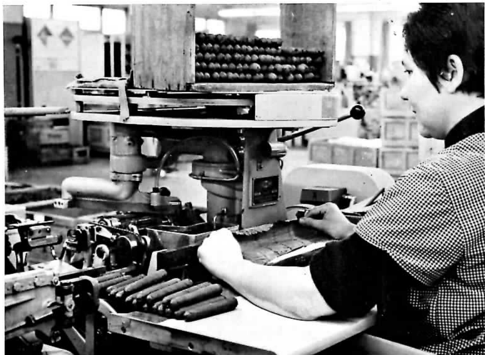
Maschinelle Aufbringung, »Überrollung« des Deckblattes
